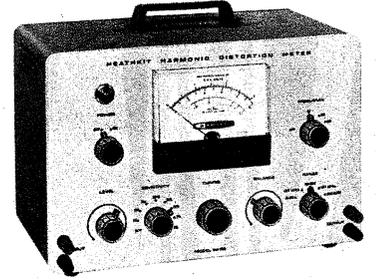
Ermöglicht in Verbindung mit einem klirrarmen NF-Generator, wie beispielsweise den HEATHKIT-Modellen IG-72 E oder IG-18 genaue Klirrfaktormessungen im Bereich zwischen 20 Hz und 20 kHz • Das Meßergebnis ist direkt auf der in Prozent geeichten Skala des hochempfindlichen Einbauminstrumentes ablesbar • Eingangswiderstand 300 k $\Omega$  • Eingangsspannung min. 300 mVeff • Fünf Klirrfaktor-Meßbereiche von 1 bis 100%, vier Spannungsmessbereiche von 1...30 Veff • Meßgenauigkeit  $\pm 5$ %
